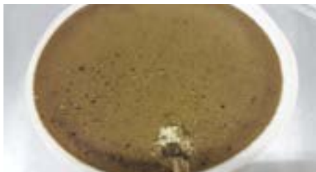
Etapa actual de refinamiento de estruvita, precipitado rico en estruvita
