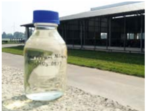
Nitrato de amonio recuperado del proceso de extracción y lavado de estiércol
