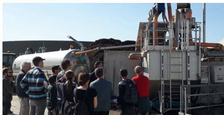
Unitat de microfiltració de digestat
