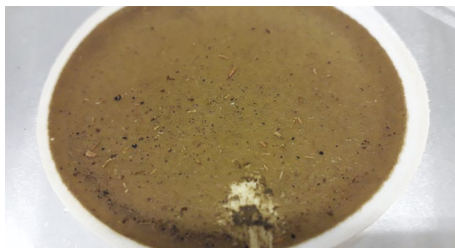
Huidig stadium van struvietraffinage, struvierijke neerslag
