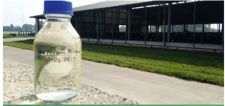
Nitrate d'ammonium récupéré du processus de stripping-scrubbing.
